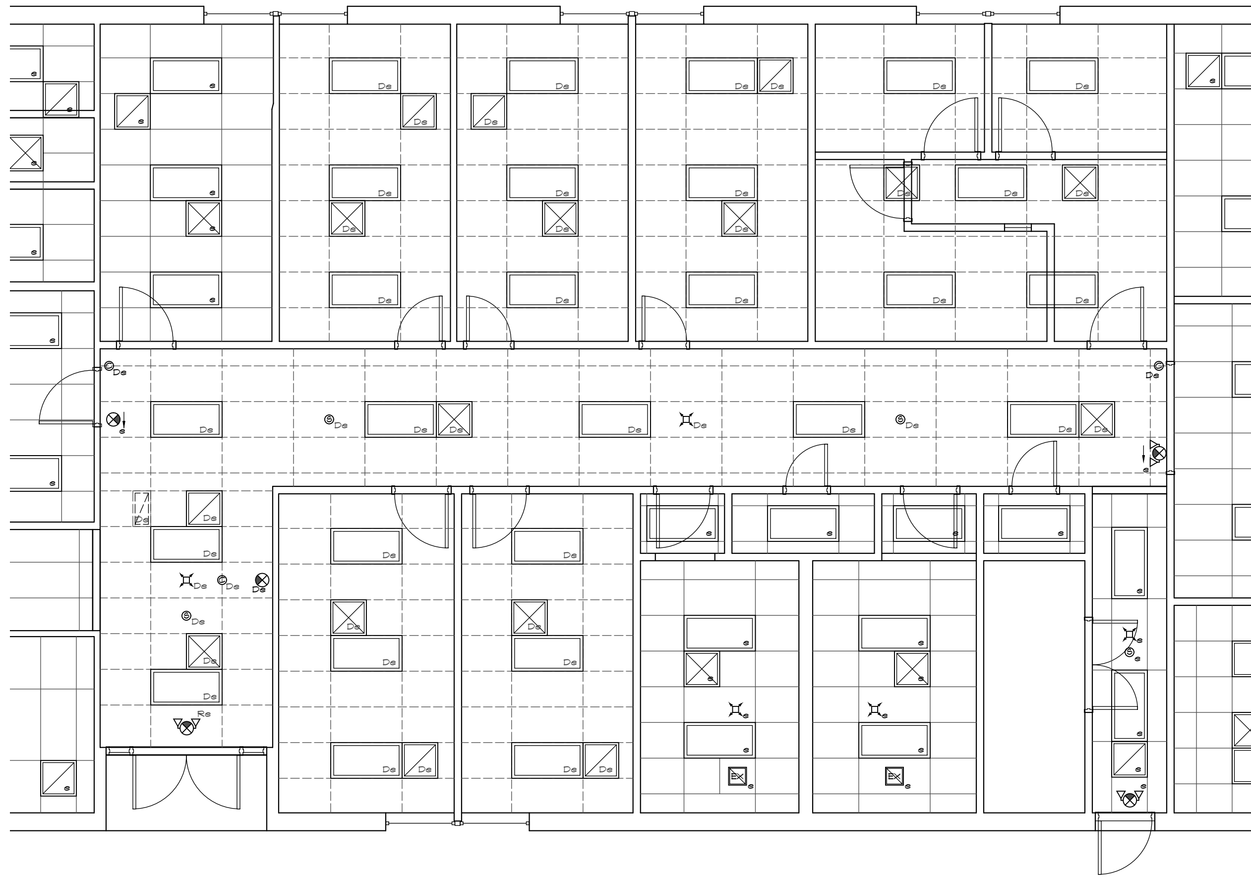
E7 A102 CEILING DEMOLITION PLAN SCALE: N.T.S.
